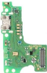
Módulo de carga para Huawei Y6s
