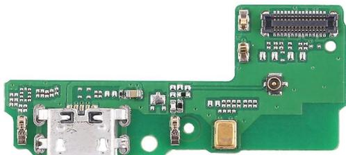
Xiaomi Redmi 5 Substituição do Módulo de Carga
